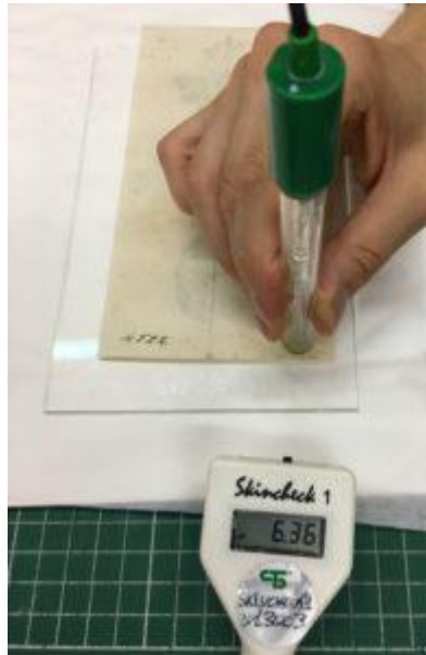
Fig. 51: Misurazione del pH della carta dell'opera inv. 4522, Musei Nazionali di Bologna, Pinacoteca Nazionale, Gabinetto Disegni e Stampe
